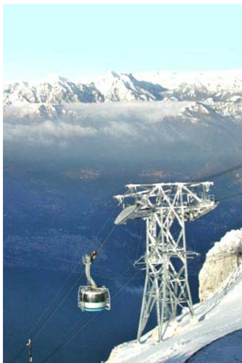
Figura 13 - funivia del Monte Baldo caratterizzata dalla cabina panoramica che ruota su se stessa per permettere di vedere il lago durante l'ascensione, (Fonte: http://www.funiviedelbaldo.it/funivia.asp )
