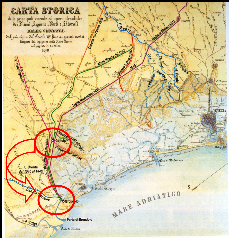
Fig. 3.2 - Le deviazioni e le nuove inalveazioni del Brenta realizzate dopo gli interventi di instaurazione attuati nel corso del XIV secolo per difendere la laguna dagli interrimenti, riportate nella carta di Pietro Marcon (1878).
