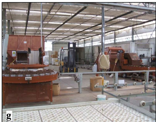
Figura 6.2 - Immagini di locali presenti all'interno di complessi serricoli di grandi dimensioni ricavati all'interno di strutture che, sebbene costruttivamente assimilabili a quelle di una serra, ne differiscono per la sistemazione della pavimentazione (adatta al passaggio di mezzi meccanici pesanti) e per l'utilizzo di materiali di copertura (in special modo sul tetto), traslucidi o addirittura opachi.
